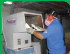
Figura 6. Fotografías del desembalaje de residuos y de la molienda de plásticos.
